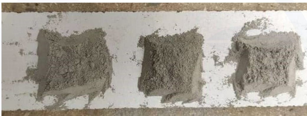
شکل ۳: نمونه پودر شده شماره دو از هر گروه بعد از هیدراتاسیون. نمونه‌ها از سمت راست به چپ به ترتیب: (نمونه شاهد ۲، نمونه M۲، نمونه N۲)
