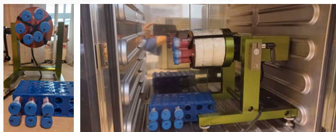
شکل ۱- کلینوستات مورد استفاده در این آزمایش و نحوه‌ی قرارگیری نمونه‌ها در شرایط میکروگراویتی (MG) و گرانش نرمال (IG)
