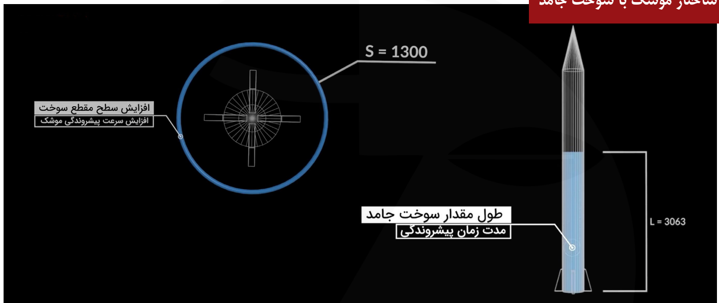
شکل ۱۳ ساختار موشک با سوخت جامد
