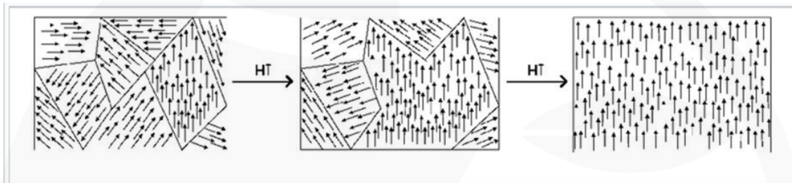
شکل ۱. چرخش جهت و افزایش اندازه‌ی حوزه‌های مغناطیسی در پاسخ به میدان مغناطیسی اعمال‌شده‌ی خارجی.
